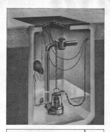
Vertikale Abwassertauchpumpe Robot Modell RW
