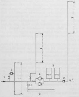
Bild 35. Prinzipschema der Wasserversorgung
