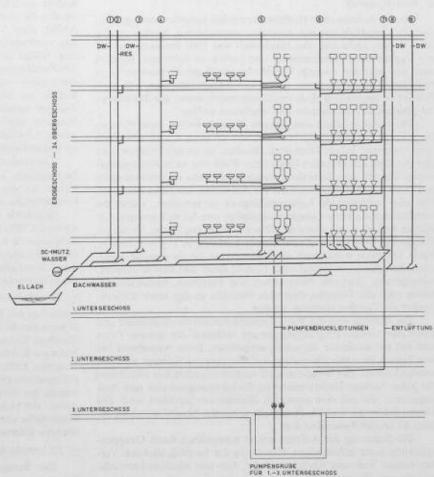
Bild 36. Prinzipschema der Abwasser-Ablaufinstallation
