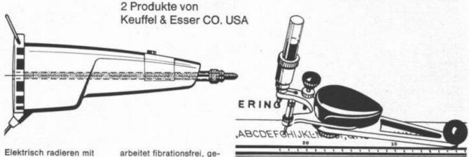
Elektrisch radieren mit dem modernen, handlichen MOTORASER geht schneller und mühelos. Mit 3600 Umdrehungen in der Minute rotiert die Gummimine und meist genügen wenige Sekunden, um Graphit, Tusche und Druckfarbe bei grösster Schonung der Papier- oder Film-Oberfläche zu entfernen. Seine Form ist anatomisch richtig und funktionsgerecht. Der leistungsstarke Motor
