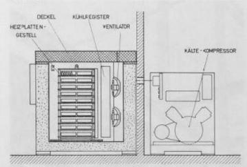
Bild 9. Einfrierapparat mit beweglichem Plattengestell
