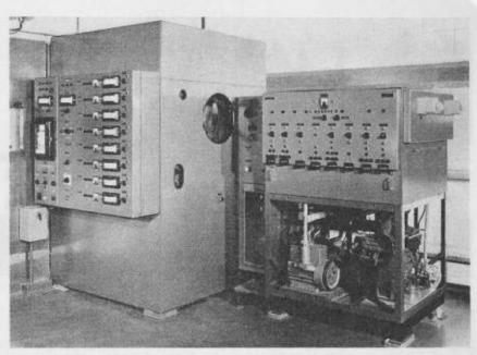
Bild 7. Gefr ertrocknungsanlage mit horizontaler Kammer
