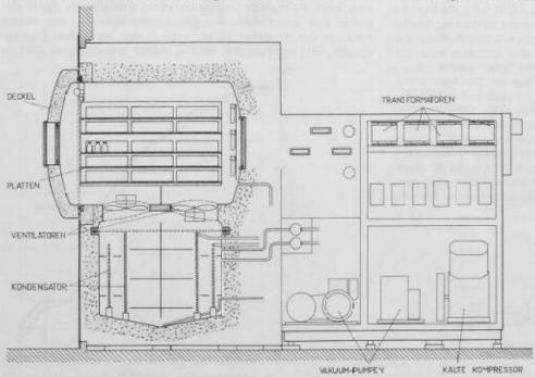
Bild 8. Schematischer Schmitt durch eine Gefriertrocknungsanlage mit horizontaler Kammer und 3,9 m² Stellfläche
