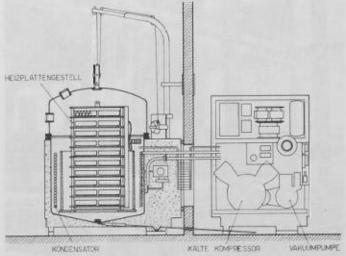
Bild 10. Gefriertrockner mit vertikaler Kammer und beweglichem Plattengestell mit 2,3 m² Stellfläche
