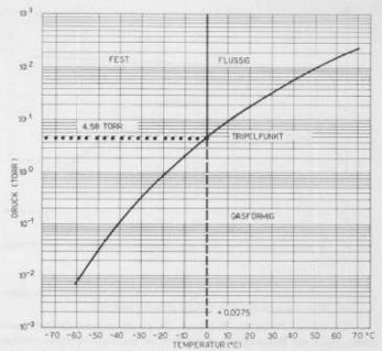
Bild 1. Spannungskurve von Wasser
