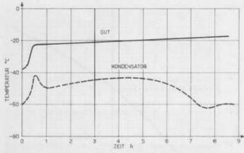
Bild 4. Temperaturver auf an Gut und Kondensator während der Primärtrocknung
