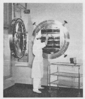
Bild 6. Vom Sterilraum aus zu bedienende Beschikkungstür eines Gefriertrockners mit horizontaler Kammer
