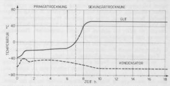
Bild 5. Temperaturverlauf an Gut und Kondensator während dem gesamten Trocknungsprozess
