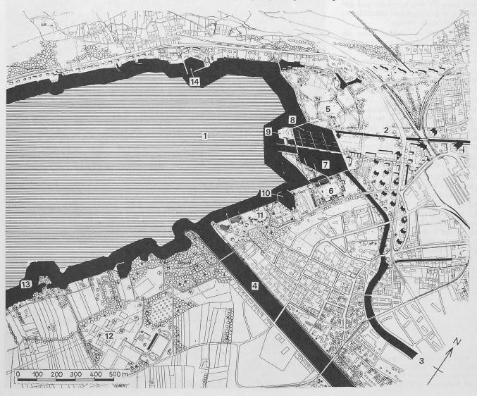
Im Kern (das heisst gleichzeitig am alten Ort) sind Bieler Strandbad, Dampfschiff- und Kleinboothafen neu gestaltet. Für das Strandbad ist mit der Erweiterung eine Umorientierung zur Sonne, die absolute Trennung gegen den Dampfschiffhafen und eine einwandfreie Durchspülung der neuen Bucht vorgesehen.
