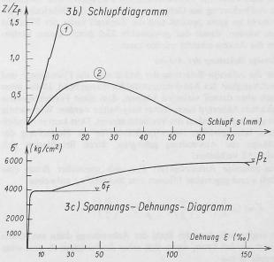
Bild 3. Ankerkennlinie, Schlupfdiagramm und Spannungs-Dehnungs-Diagramm
