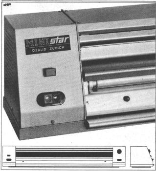
Lichtpausmaschinen für Trocken- oder Halbfeucht-
