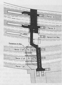
Bild 34. Führung des Fussgängerverkehrs durch die Personenunterführung während der sieben Bauphasen
