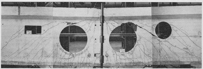
Bild 42. Rissbild des Spannbetonträgers nach erfolgtem Bruch. Das Versagen der Betondruckzone am obern Rand der rechten grossen Aussparung ist deutlich sichtbar (Photo EMPA)
