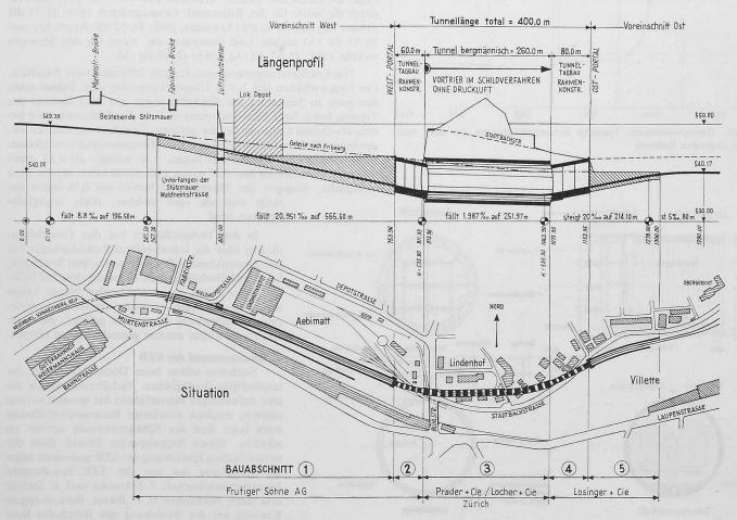
Bild 24. Donnerbühltunnel: Lageplan rd. 1:8500 und Längenprofil rd. 1:850
