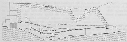
Bild 28. Schanzentunnel der SZB: Längenprofil (schematisch)
