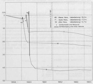
Bild 27. Donnerbühltunnel: Typische Setzungsdiagramme der über dem Tunnel liegenden Gebäude
