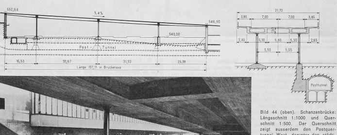
Längsschnitt 1:1000 und Querschnitt 1:500. Der Querschnitt zeigt ausserdem den Postquertunnel West, darunter den städtischen Werkleitungsstollen und daneben einen Leitungsstollen der PTT. Auf dem Längsschnitt sind links die nebeneinanderliegenden Kabel- und Gepäcktunnel im Schnitt sichtbar
