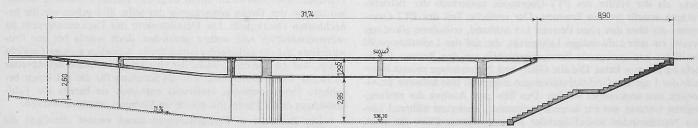
Bild 36. Querschnitt 1:250 durch Personenunterführung mit Rampe (links) und Treppe (rechts)
