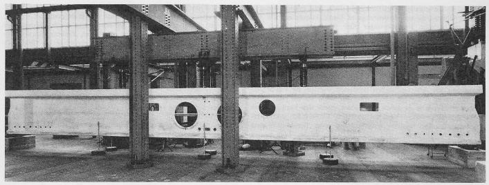
Bild 41. Bruchversuch an einem Spannbeton-Fertigträger von 14,34 m Stützweite und mit grossen Aussparungen (max.  $\phi$  80 cm) an der EMPA. Versuchsanordnung (Photo EMPA)
