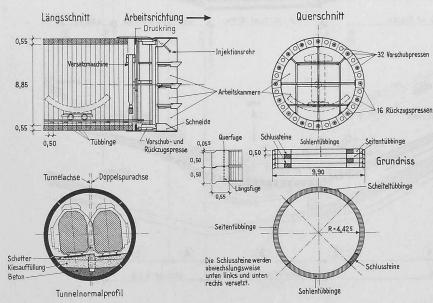
Bild 26. Donnerbühltunnel Schildvortrieb, Längs- und Querschnitt 1:400
