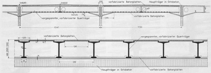
Bild 39. Perrondecke aus Beton-Fertigelementen, oben Querschnitt 1:250, unten Längsschnitt 1:100
