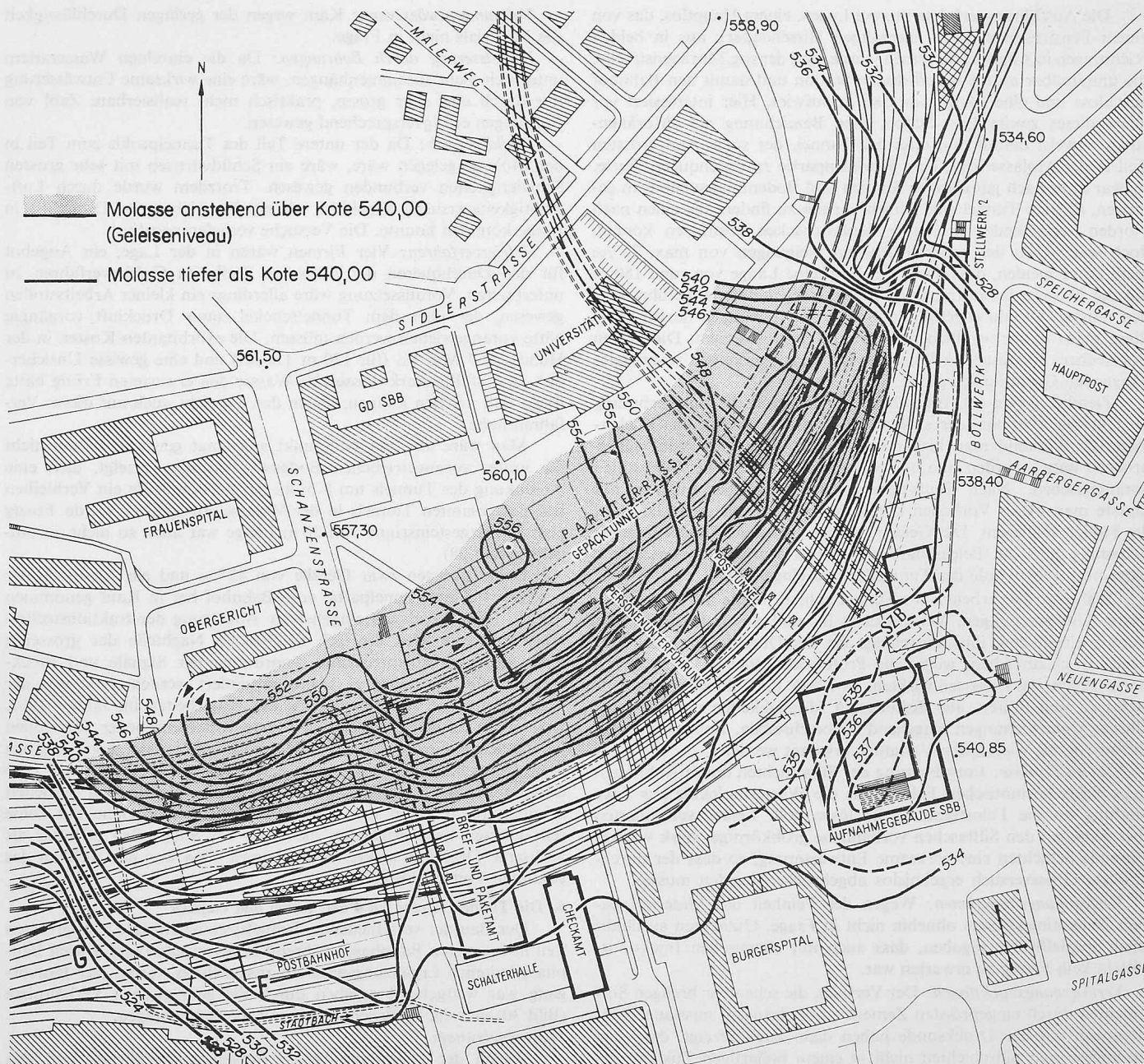
Bild 30. Geologische Verhältnisse im Bahnhof Bern. Verlauf der Molasseoberfläche. Die Perronanlage liegt im Bereich eines grossen Molasserückens, der nach drei Richtungen stark abfällt. Masstab 1:3000
