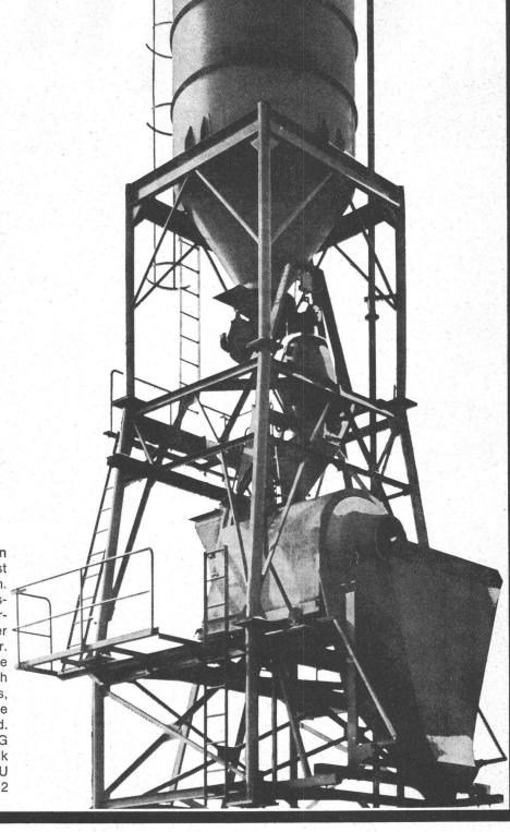
Brun-Betonieranlagen sind von äusserst robuster Konstruktion. Sie sind mit Zwangsmischer oder Reversiermischer, halb- oder vollautomatisch, lieferbar. Verlangen Sie Offerte oder den Besuch eines Fachmannes, der Sie gerne fachkundig beraten wird. Brun+Cie AG Maschinenfabrik 6244 Nebikon LU Telefon 062 9 51 12
