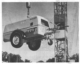
Anschlußfertige, betriebsbereite Kompressoreinheit erhältlich als Anhänger, fahrbereit ausgestattet oder als semistationäre Anlage mit Dreipunktabstützung
