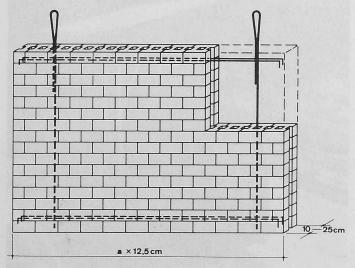
Bild 2. Schematische Darstellung des Aufbaus einer Preton-Wand
