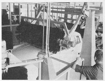
Bild 3. Die beiden koordiniert arbeitenden Dachbürsten (4) in Funktion
