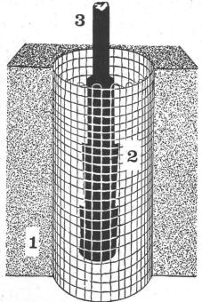
1 = Schnitt Beton 2 = Beton-Drahtkern , 3 = Eisenstück, einzubetonieren Lieferungen durch
