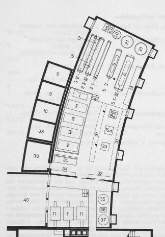
Bild 2 (links). Grundriss des Kellergeschosses im Verbindungstrakt mit Wärmepumpanlage und Heizkessel für Zentralheizung
