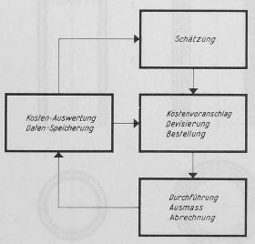
Bild 1. Zyklus der Kostenelemente von Bauten
