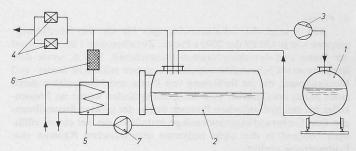
Bild 3. Vereinfachtes Schema der Propan-Abfüllanlage
