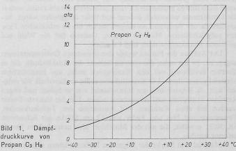
Bild 1 Dampfdruckkurve von
