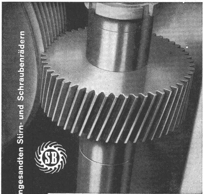
Zähneschleifen an eingesandten Stirn- und Schraubenrädern
