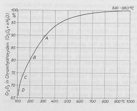
Bild 1 (links). Dehydratisierung von Chromhydroxyd
