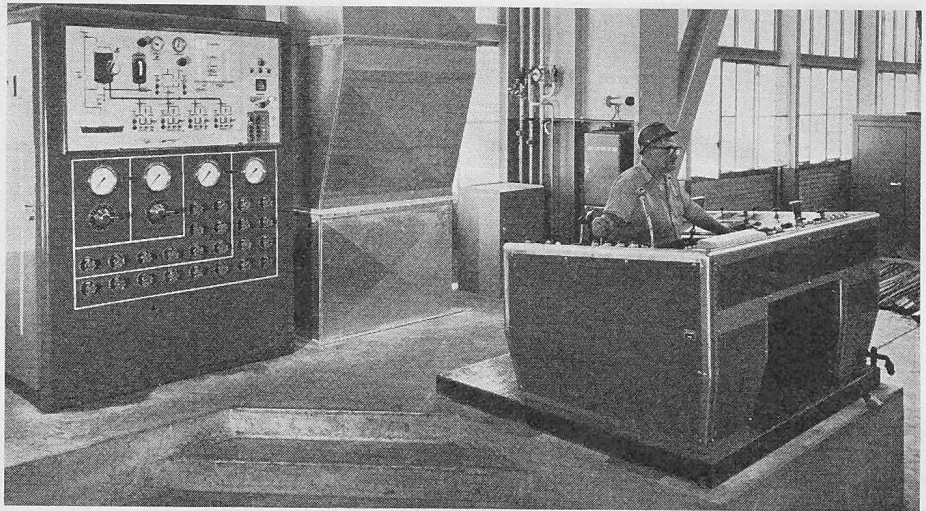
Bild 7. Bedienungspult und Ueberwachungstafel zu 2000-t-Schnellschmiedepresse
