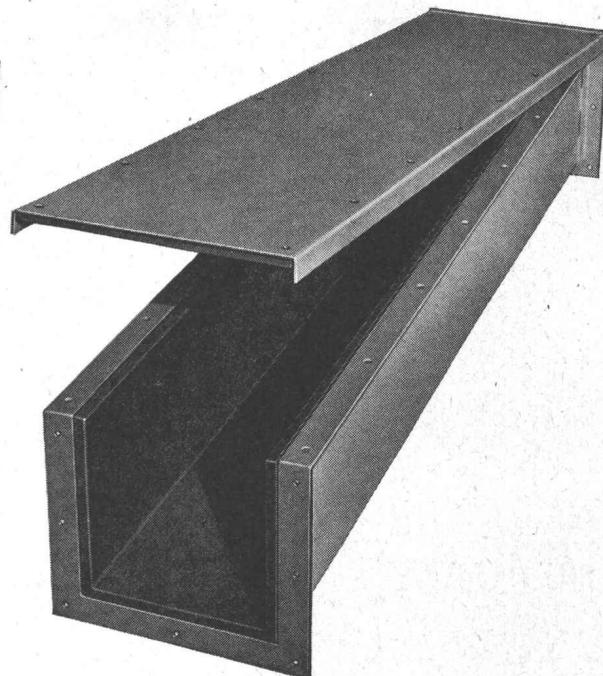
Trellex-Normkanäle sind mit Verschleiss-Schutzgummi ausgekleidet. Diese staubdichte Konstruktion ergibt längere Laufzeiten und praktisch eine geräuschlose Materialförderung. Die Dimensionen von 250×250 mm und 400×400 mm sind in den Längen 1000 mm und 1500 mm ab Lager lieferbar.
