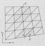
lettres romaines et aux segments du réseau, un indice en lettres grecques. Une quantité associée aux nœuds ou aux segments sera affectée de l'indice supérieur correspondant. Par exemple,  $x_1^i$ ,  $x_2^i$  sont les coordonnées du nœud i et  $L^{\alpha}$  est la longueur du segment  $\alpha$ .
