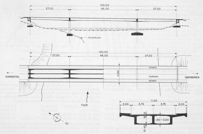
Bild 2. Längsschnitt und Grundriss 1:800. Querschnitt 1:200
