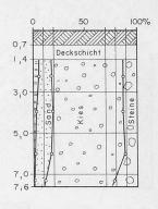
Bild 9. Schichtfolge und Körnung von aufeinanderfolgenden gemittelten Proben aus Baggerschlitzen des Henauerfeldes, Links mehr, rechts weniger Silt
