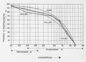
Bild 5. Kornverteilungskurven der vier einzelnen Kies-Sand-Komponenten
