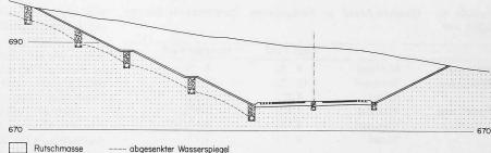
Bild 6. Typischer Querschnitt 1:1000 für den projektierten Einschnitt der N 1 westlich Oberdorf
