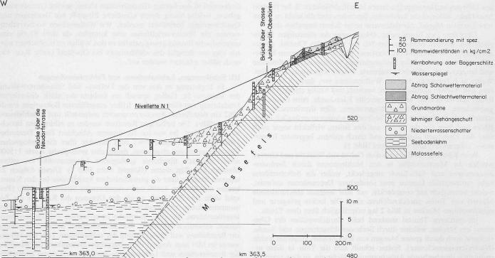
Beispiel eines typischen geotechnischen Längenprofils für das Ausführungsprojekt der N 1, Abschnitt Oberbüren-St. Gallen, Gebiet nahe südlich Niederbüren, vereinfacht
