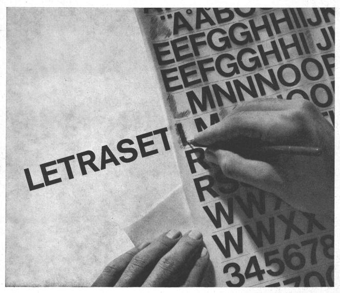
Ein revolutionäres Trockenabzug-Verfahren, das durch einfaches Reiben erlaubt, Texte, Marken und Zeichen auf jede glatte Oberfläche wie Papier, Karton, Metall, Plastik usw. zu übertragen. Diese Technik bietet dem Benutzer die einfachste, sparsamste und sicherste Methode. Letraset (trocken übertragene Schriftzeichen) ist eine ganze Druckerei in der Schublade Ihres Büros.
