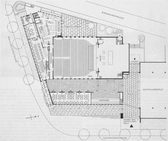
Erdgeschoss 1:500 (rechts Anschluss der früher erstellten Züspa-Ausstellungshalle)
