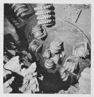
Bild 11. Zentrum des Bohrkopfes mit zwei Kegelmeisseln, in gemischter Anordnung zahn- und diskusbestückte Rollmeissel
