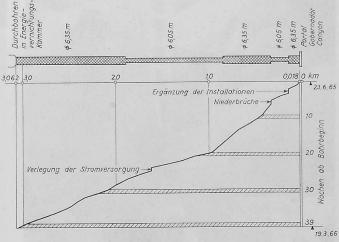
Bild 9. Zeitlicher Verlauf des Tunnelbohrens, Bohrdurchmesser-Zonen
