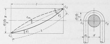
Bild 5. Abwicklung des Zylindermantels in dem an der Ueberschlagstelle a die Zugseilaxe liegt
