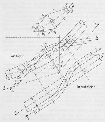
Bild 4. Gleichgewichtsverhältnisse an einer Ueberschlagstelle a mit  $x \le x$ \* bei der Wirkung einer Reibung zwischen Trag- und Zugseil. Verformung der Seile stark verzerrt dargestellt
