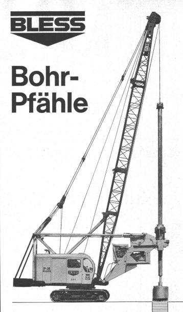
Pfahldurchmesser 80-120 cm Pfahllänge bis 30 m Pfahlfussdurchmesser 240-360 cm Tragkraft pro Pfahl bis 900 t
