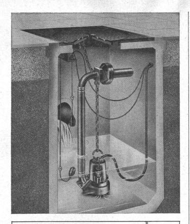
Vertikale Abwassertauchpumpe Robot Modell RW
