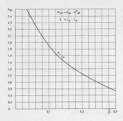
Bild 4. Abhängigkeit des Stützenmomentes von den Pilzabmessungen. Für quadratische Pilze:  $D=1.13\ d$
