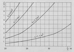
Bild 3. Konstruktionsbedingungen der Flachdecken bei  $\tau_{\rm nom} \le 0,65~\tau_1~{\rm und}~\beta_d = 300~{\rm kg/cm^2}$
