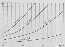
Bild 2. Konstruktionsbedingungen der Flachdecken bei  $\tau_{\rm nom} \leqslant$  1,0  $\tau_{\rm 1}$  und  $\beta_{d}=300~{\rm kg/cm^2}$
