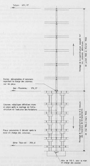
d'être signalée et pourrait être utilisée dans tous les chantiers, nécessitant de grandes excavations en terrain médiocre et où les programmes de travaux sont très serrés. Le chantier était desservi par deux grues tours de 90 et 200 mt. Le rythme de montage de la charpente a varié de 70 à 150 t par mois pour les sous-sols et a atteint des pointes de 500 t par mois pendant le montage des superstructures.
