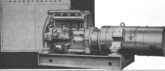
24 KVA, 3 x 380 V, 50 Hz, mit Dieselmotor Leistungsbereich: ab 600 W, nach oben unbeschränkt
