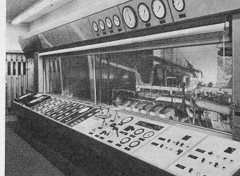
Bild 24. Entwicklungsprüfstandsboxe mit 12-LVA-24-Motor
