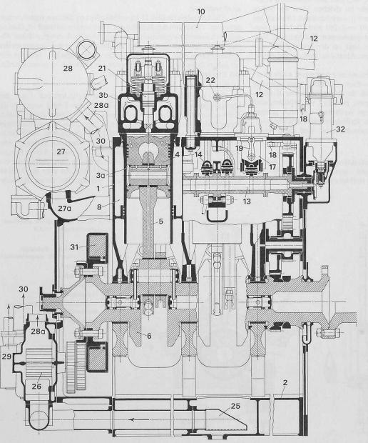
Bild 10. Längsschnitt durch einen Motor der LVA-24-Reihe, 1:15
