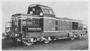
Bild 27. Lokomotive 040 DG 501 der SNCF mit 8-LVA-24-Motor für leichten Güterzusshetrieh
