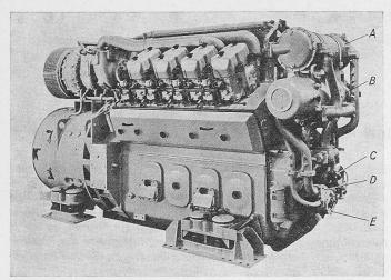
Bild 1. Prototypmotor 8 LVA 24 A Oelkühler, B Schmierölfilter, C Schmierölpumpe, D Kühlwasserpumpe für Zylinder, E Kühlwasserpumpe für Ladeluftkühler
