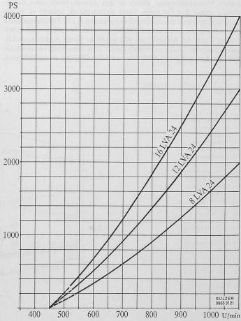
Bild 26. Leistungscharakteristik der LVA-Motoren
