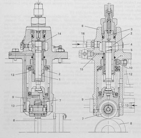
Bild 18. Brennstoffpumpe
