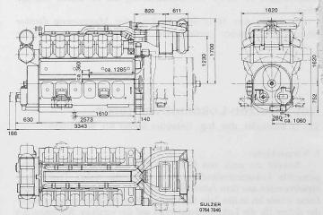
Bild 4. Massbild des Lokomotivdieselmotors 12 LVA 24
