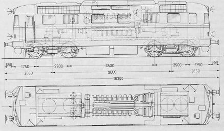
Bild 29 (oben). Projekt einer dieselhydraulischen 4000-PS-Lokomotive mit 16-LVA-24-Motor, Achsanordnung B<sub>0</sub> B<sub>0</sub> Dauerleistung des Motors: 4000 PS bei 1100 U/min Dienstgewicht mit vollen Vorräten: 83 t Maximale Anfahrzugkraft: 28 000 kg Dauerzugkraft: 21 000 kg bei 34 km/h Maximale Geschwindigkeit: 140 km/h
