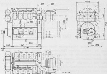
Bild 2. Massbild des Prototypmotors 8 LVA 24
