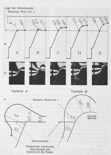
Bild 7. Photoelastische und Strain-Gauge-Untersuchungen an Zylinderblockrippen
