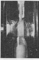
Bild 8b. Strömung im Modell mit Bläschenbildung
