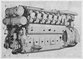
Bild 3. Lokomotivdieselmotor 12 LVA 24 A Oelkühler, B Schmierölfilter, C Schmierölpumpe, D Kühlwasserpumpe für Zylinder, E Vorschmierpumpe, F Pumpenmotor, G Brennstoff-Zubringerpumpe
