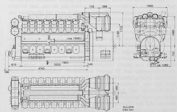
Bild 6. Massbild des Lokomotivdieselmotors 16 LVA 24
