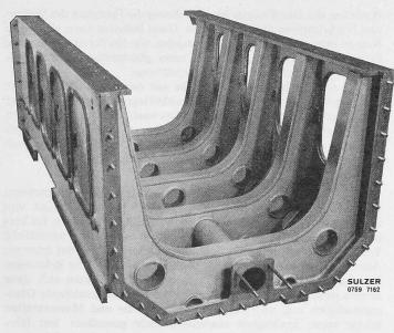
Bild 11. Grundplatte des 8-LVA-24-Motors
