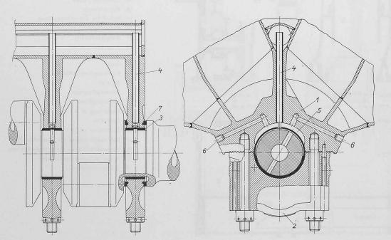
Bild 12. Im Zylinderblock eingebautes Kurbelwellenlager, 1:12,5
