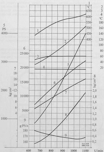
Bild 25. Messwerte des 16-LVA-24-Motors
