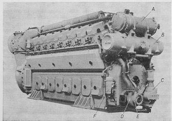
Bild 5. Lokomotivdieselmotor 16 LVA 24 A Oelkühler, B Schmierölfilter, C Schmierölpumpe, D Kühlwasserpumpe für Zylinder, E Kühlwasserpumpe für Ladeluftkühler, F Reglerölfilter
