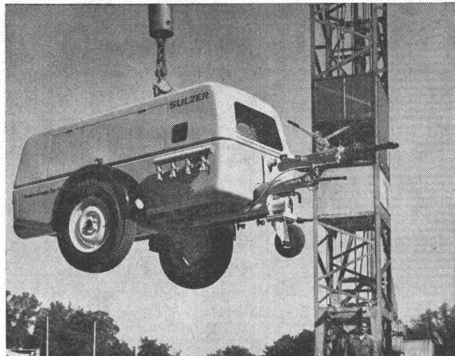
Anschlußfertige, betriebsbereite Kompressoreinheit erhältlich als Anhänger, fahrbereit ausgestattet oder als semistationäre Anlage mit Dreipunktabstützung
