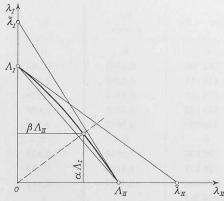
Bild 3. Zusammenhang zwischen den kritischen Lasten der Teilprobleme I, II und des Gesamtproblems
