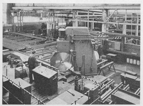
Im Stahlbau-Betrieb spielt der Aufwand für die Manipulation eine grosse Rolle. Bei der typisierten Konstruktion kann dieser Aufwand durch den Einsatz von speziellen Heftund Drehvorrichtungen stark herabgesetzt werden.
