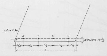
Bild 2. Anordnung und Bezeichnungen der Auflagerpunkte
