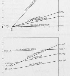
Bild 5. Vergleich der Kostenentwicklung Stahlkonstruktion-Ortbeton
