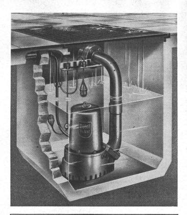
Robot-Schmutzwassertauchpumpe Modell P
