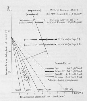
Bild 4. Diagramm zur Bestimmung der Wirtschaftlichkeit von Spitzenlast-Gasturbinenanlagen
