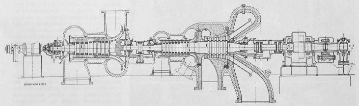
Bild 22. Länggschnitt durch die Gasturbine von 10 MW der Anlage Nowokaschirsk, Masstab etwa 1:60
