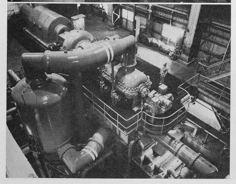
Bild 25 (links). Maschinengruppe Oberhausen. Rechts Niederdruck-Kompressor mit Hochdruck-Kompressor und Turbine, links Planeten-Reduktionsgetriebe, im Vordergrund das Kommandopult
