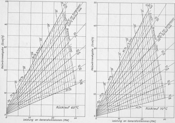
Bild 5b. Kennfelder eines Gasturbinen-Heizkraftwerkes von 25 MW; Heizwasserrücklauftemperaturen 60 bzw. 70 ° C
