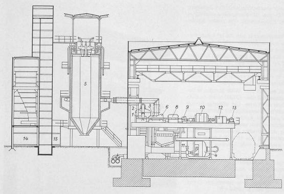
Bild 29. Anordnung der Gasturbinenanlage von 6,3 MW Haus Aden
