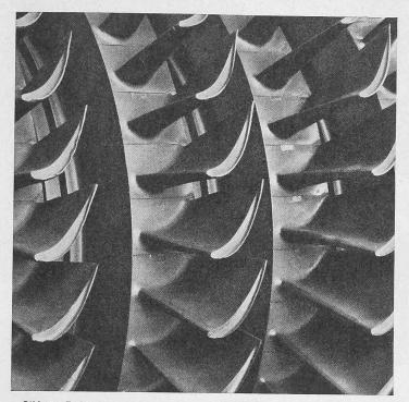
Bild 17. Turbinenbeschaufelung der Heissluftturbinenanlage Ravensburg nach 27 200 Betriebsstunden ohne Belage und Korrosionserscheinungen
