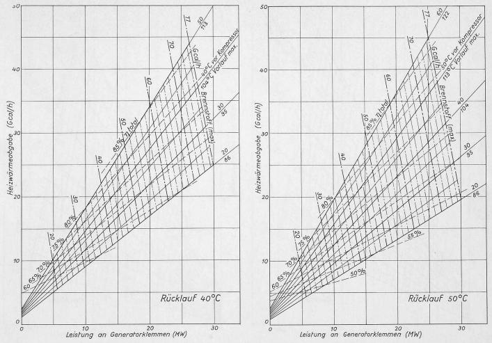
31ld 5a. Kennfelder eines Gasturbinen-Heizkraftwerkes von 25 MW; Heizwasserrücklauftemperaturen 40 bzw. 50 ° C
