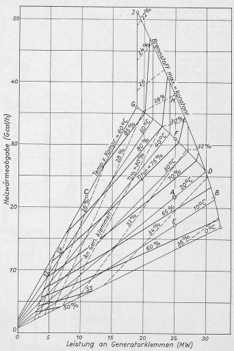
Bild 4. Kennfeld eines Gasturbinen-Heizkraftwerkes von 25 MW-Nennleistung bei Oel- oder Gasfeuerung und den Heizwasser-Temperaturen 90 °C im Vorlauf und 50 °C im Rücklauf
