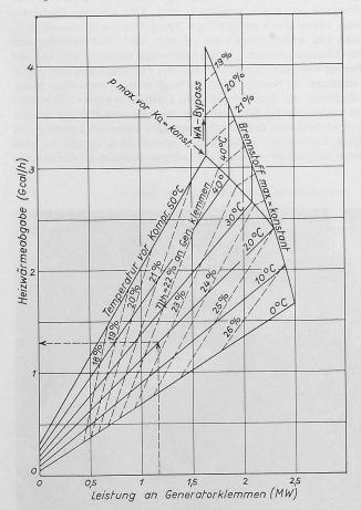
Bild 16. Kennfeld des Heizkraftwerkes Ravensburg mit Kohlenstaubfeuerung
