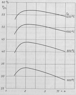
Bild 8. Wirkungsgrade von Gasturbinen-Anlagen mit Heliumkreislauf für verschiedene Expansionsverhältnisse  $\pi$  und Turbinen-Eintrittstemperaturen  $t_{\sigma}$
