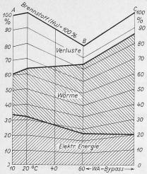
Bild 3 (links). Wärmebilanz einer Gasturbine von 25 MW mit geschlossenem Kreislauf in Abhängigkeit von der Temperatur der Kreislaufluft vor dem Kompressor
