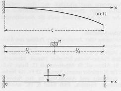
Bild 8 (oben). Querschwingungen eines Stabes
