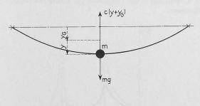
Bild 1. Schwinger mit Freiheitsgrad eins;
