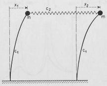
Bild 2. Schwinger mit Freiheitsgrad zwei;
