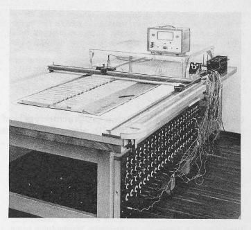
elektrisches Feld nachzubilden, das messtechnisch viel besser zugänglich ist. Selbstverständlich muss dafür gesorgt werden, dass alle Randbedingungen des thermischen Problems in streng analoger Art elektrisch nachgebildet werden.
