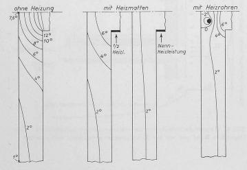
Bild 5. Isothermenfelder in der Uebrgangsstelle Wand — Zwischenboden. Kotierung der Kurven in  $^{\circ}\mathrm{C}$  unterhalb der Aussentemperatur.
