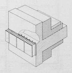
Bild 6 (rechts). Schutz der Uebergangsstelle mit Hilfe von aussen angebrachter Rippen. Dank der erheblichen Oberflächenvergrösserung durch die Rippen,
