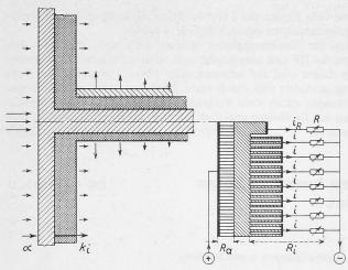
Bild 3. Nachbildung der Wirklichkeit mit dem elektrischen Analogiemodell. Aus Symmetriegründen braucht nur eine Hälfte der Uebergangsstelle Kühlhauswand—Zwischenboden nachgebildet zu werden.
