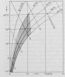
Bild 10. i, x-Diagramm für feuchte Luft.
