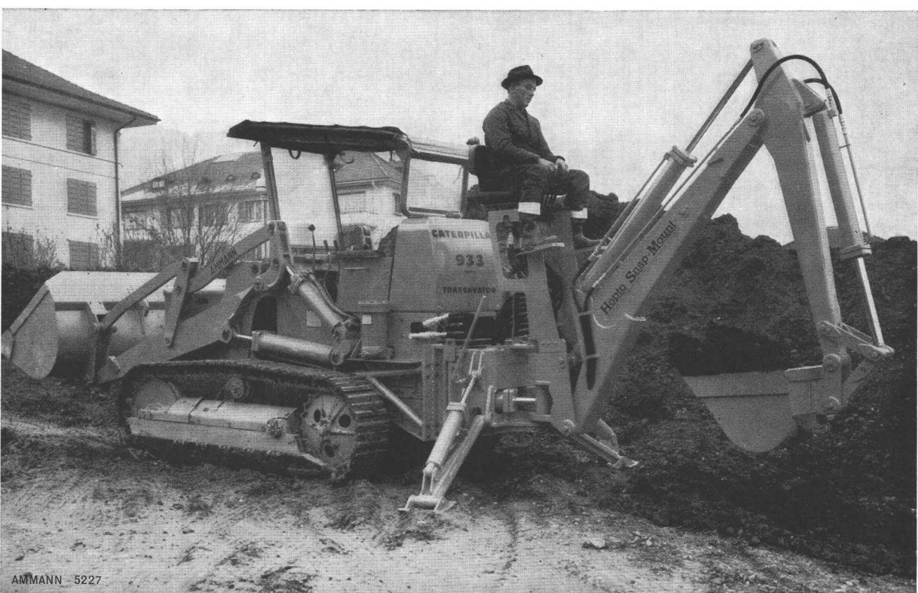
Der Hopto-Tieflöffel 110 E erhöht den Auslastungsgrad ihres Traxcavators 933 F. Grosse Beweglichkeit dank raschem An- und Abbau des Tieflöffels.
