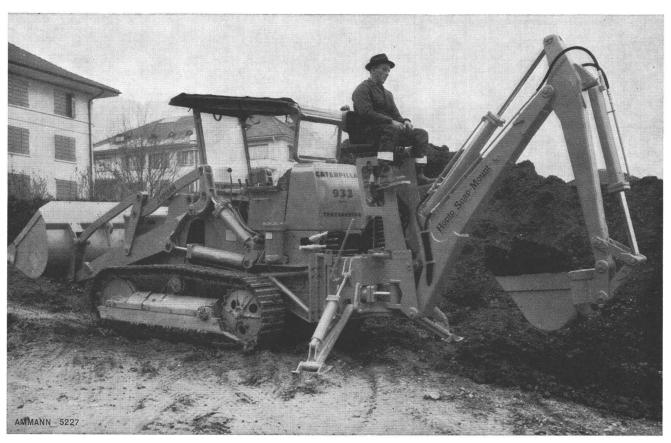
Der Hopto-Tieflöffel 110 E erhöht den Auslastungsgrad ihres Traxcavators 933 F. Grosse Beweglichkeit dank raschem An- und Abbau des Tieflöffels.
