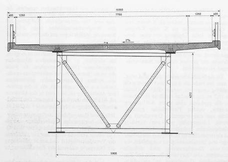
Bild 5. Querschnitt im Feld mit Querverband, Masstab 1:1000
