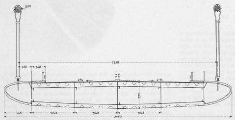
Bild 2. Versteifungsträger 1:200
