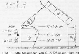
Bild 3. Alte Messungen von G. Eiffel zeigen, dass bei eckigen Formen die Druckverteilung (dimensionslos) bei grossen und kleinen Modellen praktisch gleich ist
