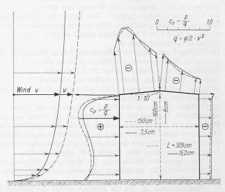
Bild 4. Messungen von M. Jensen in natürlichem Wind (grosses Modell) und im Windkanal (kleines Modell) zeigen gute Übereinstimmung. Hier ist darauf geachtet worden, dass die Windverteilung mit der Höhe geometrisch ähnlich ist: u/V = f(y/H); Bezeichnungen siehe Bild 1
