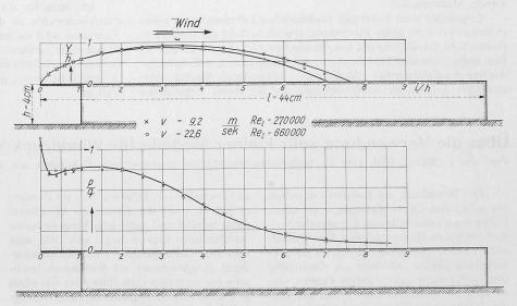
Bild 5. Wieder-Anliegen einer abgelösten Strömung auf einem Flachdach (mit Vordach). Sowohl die Grenzen der Ablösungszone (oben) als auch die Drücke (unten) zeigen nur geringe Änderungen mit der Reynolds-Zahl Re = V l/v
