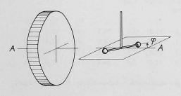
Bild 2 (links). Drehwaage-Experiment von Friedlaender
