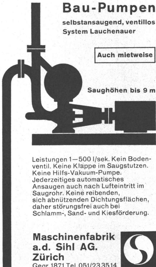
Leistungen 1–500 l/sek. Kein Bodenventil. Keine Klappe im Saugstutzen. Keine Hilfs-Vakuum-Pumpe. Jederzeitiges automatisches Ansaugen auch nach Lufteintritt im Saugrohr. Keine reibenden, sich abnutzenden Dichtungsflächen, daher störungsfrei auch bei Schlamm-, Sand- und Kiesförderung.
