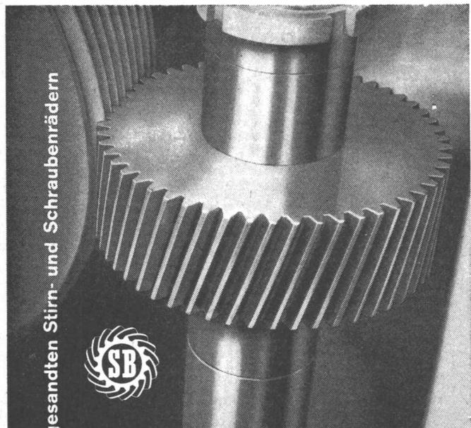
Zähnenschleifen an eingesandten Stirn- und Schraubenrädern
