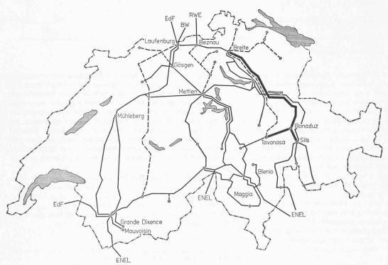
Bild 1. Leitungen des schweizerischen Höchstspannungsnetzes; Ausbauzustand Ende 1964. Fette Linien: Leitungen mit 380 kV im Betrieb.
